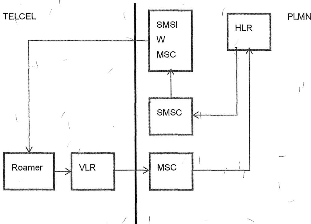
Cuando un Usuario Final envía un SMS proveniente del Concesionario y/u otro operador, el VLR de Telcel invoca el procedimiento de envío de mensaje MAP MO hacia el SMSIW MSC en la red
