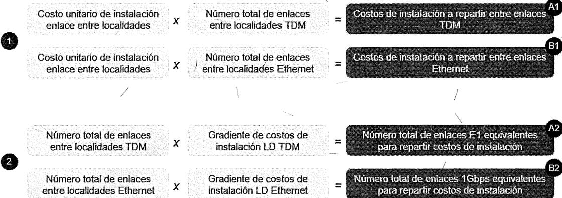
Partiendo de esta información se calcula el costo de instalación para los enlaces de referencia (E1 equivalente para TDM y 1GE equivalente para Ethernet) y a continuación se aplica un gradiente basado en los precios de instalación actuales de Telmex.
